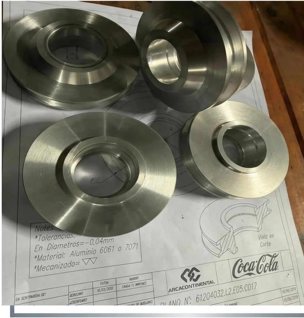
Componentes mecanizados en Aluminio 6061 · Plano certificado
